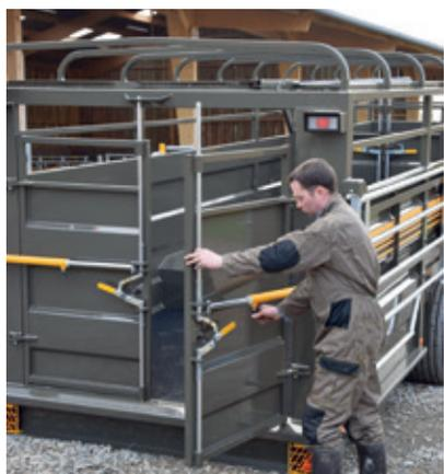
Système de guidage des portes arrière par vérins sécurisés "brevetés"
