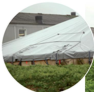
Une porte zippée relevable par une cordelette nylon permet d'insérer un malaxeur pour homogénéiser le lisier.
