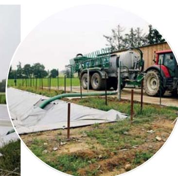
Le digestat est recueilli par une pompe et épandu à l'aide d'un pendillard.
