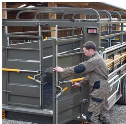
Système de guidage des portes arrière par vérins sécurisés "brevetés"
